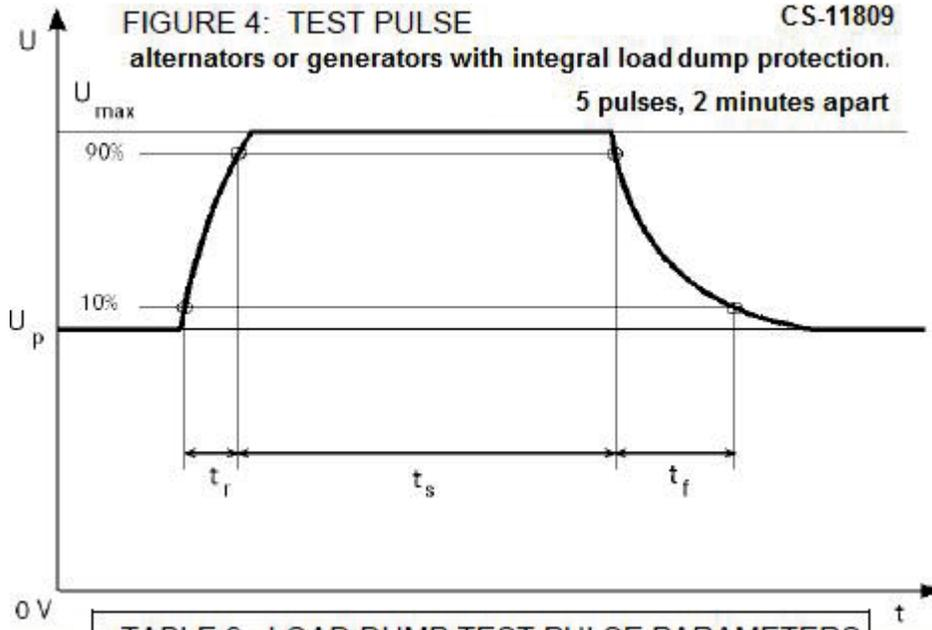
**TABLE 9: LOAD DUMP TEST PULSE PARAMETERS**
